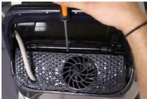
7.1. Mit Hilfe eines flachen Schraubenziehers nehmen Sie die Gitterabdeckung ab.
