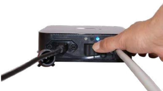
4.9 Schließen Sie das Netzteil an die nächstgelegene Steckdose an. Drücken Sie die Taste am Netzteil, die blaue Kontrollleuchte leuchtet auf. Damit aktivieren Sie das Netzteil.
