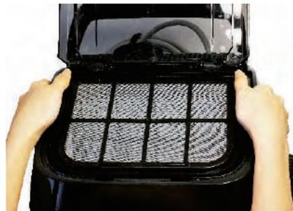
6.5 Schließen Sie den Korb nach der Reinigung wieder und setzen Sie ihn in den Roboter ein. Wenn der Korb nicht richtig ausgerichtet ist, lässt sich die Korbabdeckung nicht schließen.
