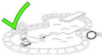
4.11 FUm die optimale Leistung zu gewährleisten, platzieren Sie den Reiniger in den Pool so weit wie möglich vom Netzteil entfernt. Damit erhalten Sie die optimale Kabellänge, damit der Reiniger die gesamte Poolfläche reinigen kann.
