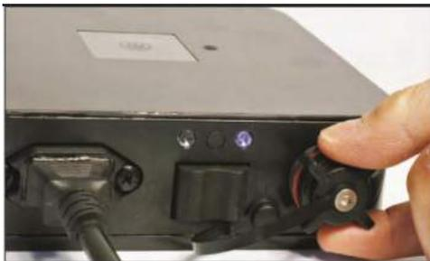
4.1 Schrauben Sie den Deckel der Buchse neben dem Schalter des Netzteils ab.
