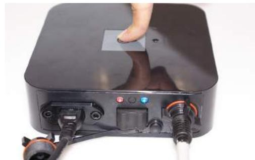
4.10 Durch Drücken der Start-Taste oben auf dem Netzteil schalten Sie den Roboter ein. Die rote Kontrollleuchte leuchtet auf. Am Ende des Filterzyklus schaltet sich der Reiniger ab und die rote Kontrollleuchte erlischt. Der Filterzyklus dauert ca. 2 Stunden.
