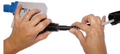
4.3 Das zweite Ende des Schwimmkabels stecken Sie in die schwarze Buchse mit der Aufschrift „POWER“ auf dem Dosierschwimmer. Beachten Sie die Ausrichtung des Steckers und der Buchse.
