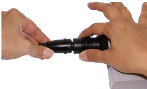
4.4 Den Kabelstecker lockern Sie durch Verschieben der aufgesteckten Schraubmutter.
