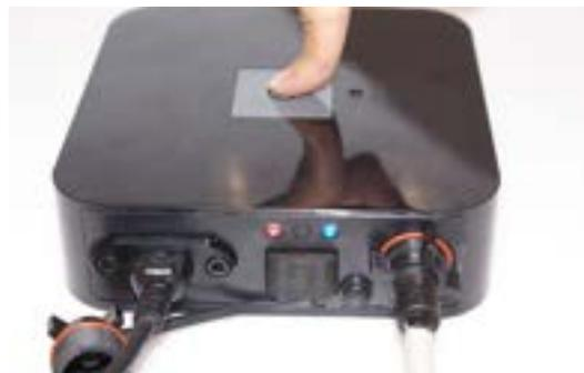
5.10 Drücken Sie den Ein-/Aus-Schalter oberhalb des Transformators, um den Reiniger einzuschalten. Es erscheint ein rotes Licht. Am Ende des Reinigungszyklus schaltet sich das rote Licht ab.
