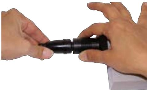
5.4 Verschieben Sie die Abdeckkappe, um den Stecker der schwimmenden Drehgelenkdurchführung zu berühren.
