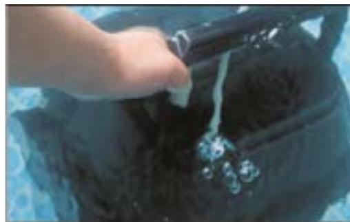
5.8 Setzen Sie den Reiniger in den Pool und warten Sie, bis dieser vollständig eingetaucht ist. Bei Bedarf helfen Sie beim Versenken manuell nach, bis die Luft aus dem Gerät entwichen ist.
